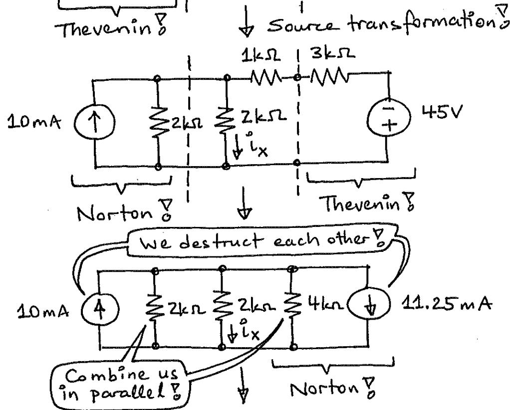
$$\frac{(2k\Omega)(4k\Omega)}{6k\Omega} = \frac{4}{3} k\Omega$$
